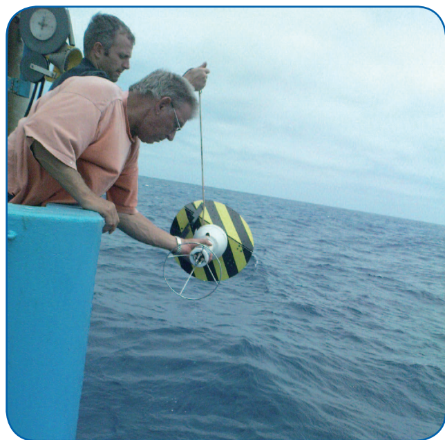
De tewaterlating van een meetsonde vanaf het meetschip de Pelagia van het Koninklijk Nederlands Instituut voor Onderzoek der Zee (NIOZ).
