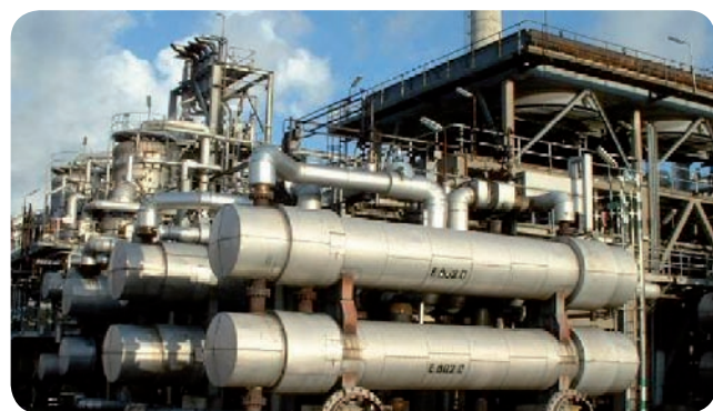
Links een foto en rechts een dwarsdoorsnede van een warmtewisselaar
