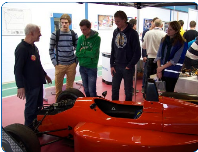
Theo Cornelissen legt tijdens een Careerday het principe van de balans van een racewagen uit. Bovenin de neus zie je een veerschokdemper-unit.
