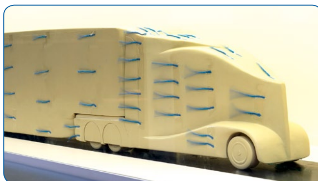
Een model van een gestroomlijnd truckmodel in de windtunnel
