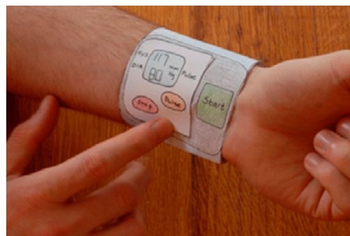
Voorbeeld van een gebruikerstest van een bloeddrukmeter met behulp van een papieren prototype
