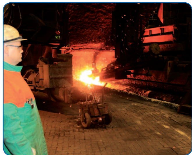
Een tapgat van een hoogoven wordt open geboord en het ruwijzer stroomt naar buiten.
