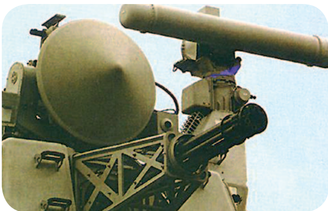
De Koninklijke Marine gebruikt parabolische antennes in geavanceerde systemen zoals deze Goalkeeper, een verdedigingssysteem tegen vijandelijke raketten.
